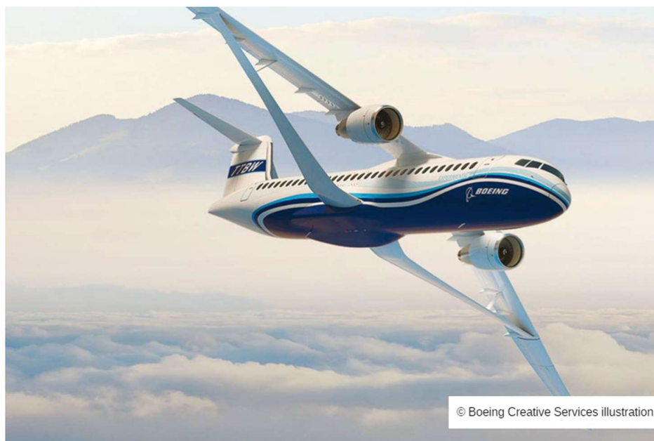
Le TTBW (Transonic truss-braced wing) de Boeing, conçu en partenariat avec la Nasa, est un concept d'ailes haubanées transsoniques.
