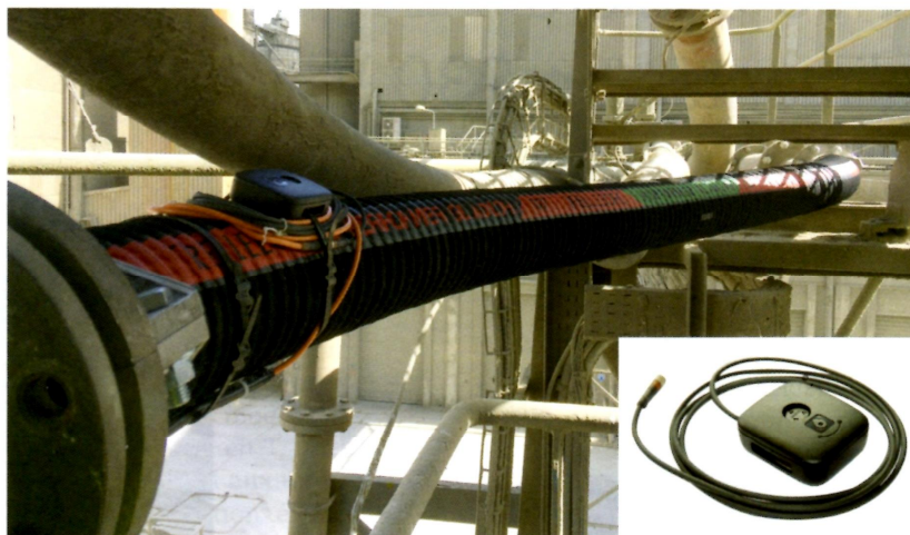
Le système WIS de contrôle d'usure des tuyaux est une des façons dont Trelleborg fait aujourd'hui de l'internet des objets une réalité dans les environnements de fabrication.
