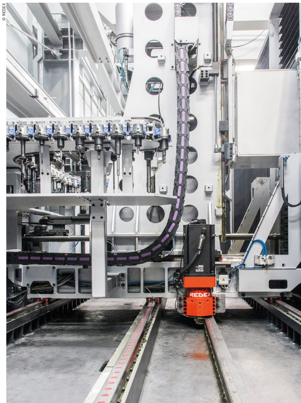
Centre d'usinage à table fixe et montant mobile Ibarria ZVH multiprocess, vue de côté. L'axe X est entraîné par un ensemble pignon et crémaillère dont l'un des deux réducteur Redex est reconnaissable à sa couleur orange.
