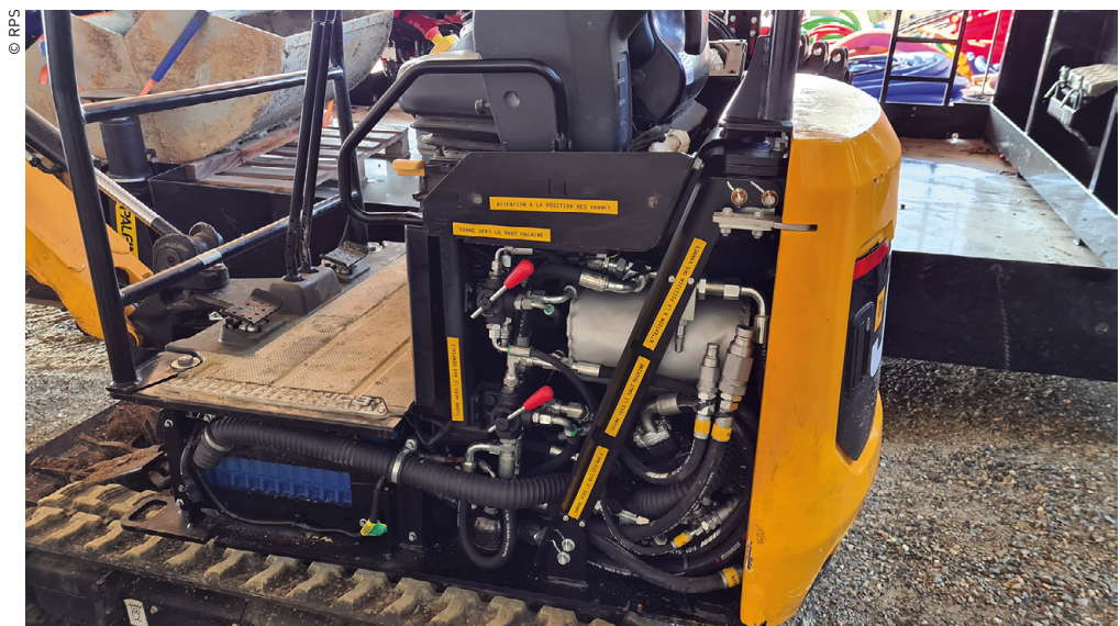
RPS a participé à la préparation de l'alimentation d'une mini-pelle JCB par un moteur électrique.
